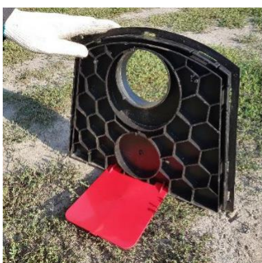
Instalar el deflector.
